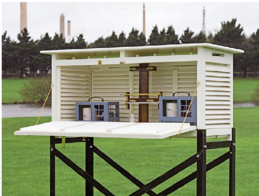
FIGURA 1.16 ↓ La capannina meteorologica protegge gli strumenti dalla radiazione solare diretta e dalle precipitazioni, ma consente la circolazione dell'aria. Gli strumenti al centro rilevano umidità e temperatura e i dati vengono raccolti dai registratori visibili ai lati.
